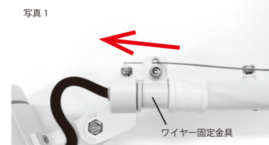
写真 1 ①ワイヤー固定金具の穴にワイヤーを手前側から奥に向けて差し込みます。
