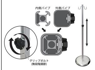
スマートガイドポールのスライド構造は、一回り太い 角パイプの内側にあるでっぱりを細い角パイプの溝に スライドさせているので無段階に調節可能ですが、 重なり部分を25mm以下にすると、ネジのトルクが 掛からず、外れてしまう可能性がありますので2本の パイプの重なり部分は、必ず25mmまでを保って ネジ留めしてください。
