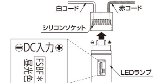
※ LEDランプはシリコンソケットの奥までしっかりと差し込んでください。差し込み不十分な場合電装品の故障、発煙、火災の原因となります。
