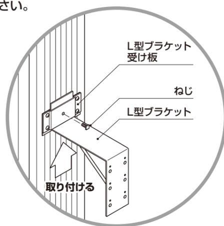
3.L型ブラケットカバー（オプション）を取り付けます。L型ブラケット包み込むようにして、L型ブラケットカバーの側面・上部でねじ止めします。
