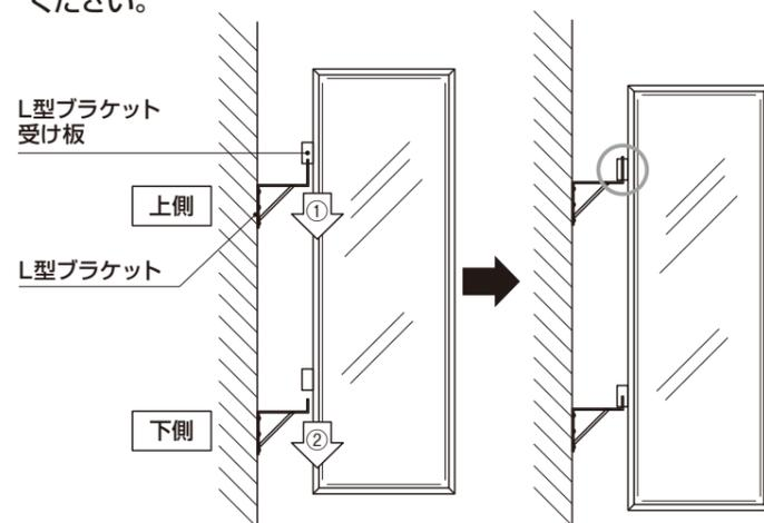
2.L型ブラケット受け板からL型ブラケットが抜けないように、ねじでしっかり締め付けてください。
