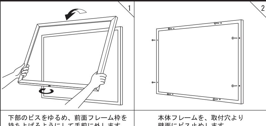
下部のビスをゆるめ、前面フレーム枠を持ち上げるようにして手前に外します。
