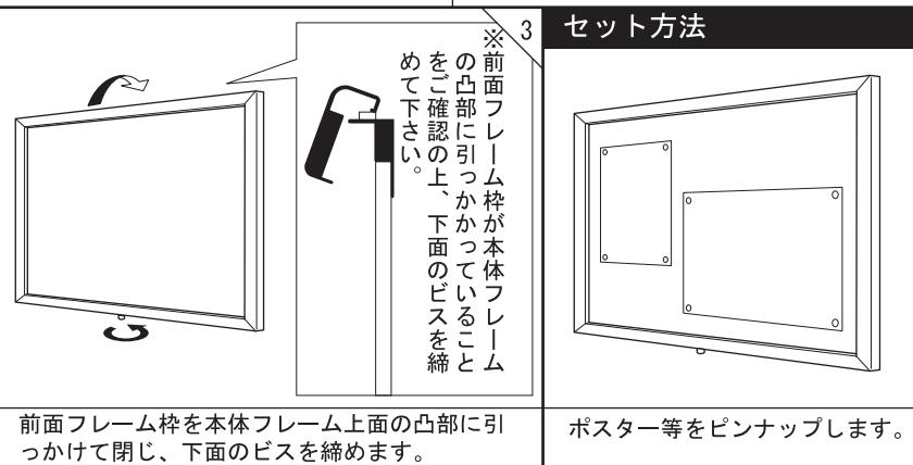
前面フレーム枠を本体フレーム上面の凸部に引っかけて閉じ、下面のビスを締めます。
