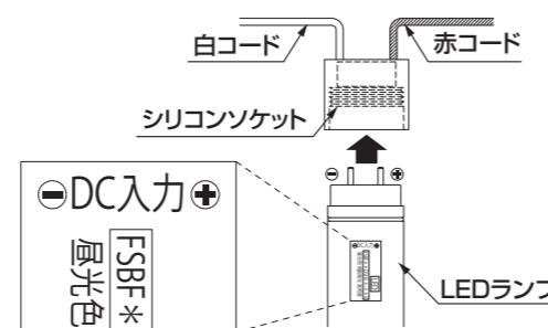
※LEDランプはシリコンソケットの奥までしっかりと差し込んでください。差し込み不十分な場合電気用品の故障、発煙、火災の原因となります。
