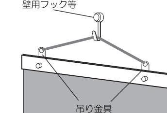
壁用のフックを準備した後、吊り金具に吊りひもをかけて、吊るします。
