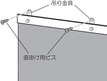
付属の直掛け用ビスを使って、吊り金具の穴で壁に吊ります。
