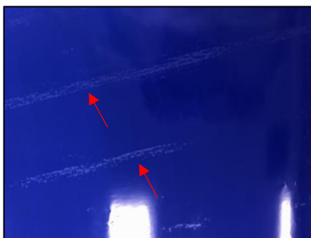
写真．フィルム表面のインプレッション外観(赤矢印箇所)
