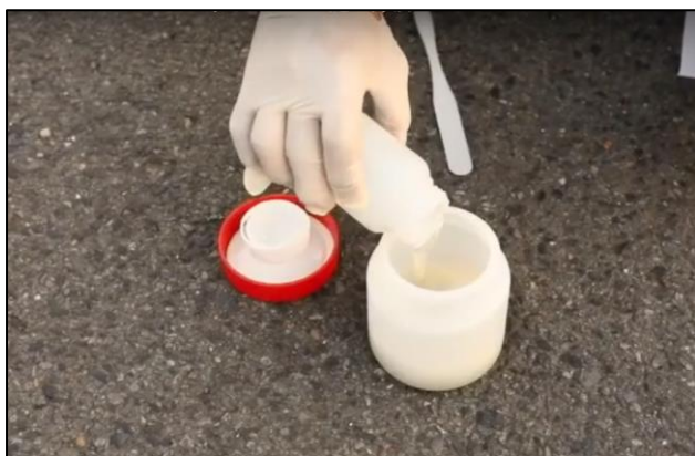
写真．主剤と硬化剤の混練およびフィルム上へのオーバーコート剤塗布
