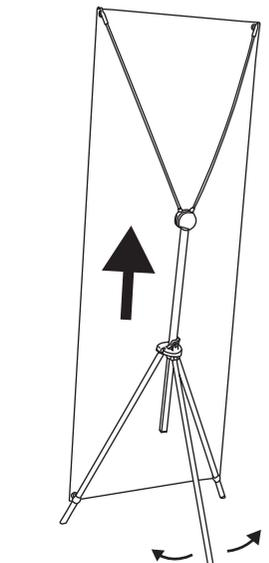
バナースタンド取り付け後背面のロックを解除してバナースタンドがしっかりと張るまで高さを調節します。調節後はしっかりとロックしてください。後ろ足の角度を適切な角度にして完成
