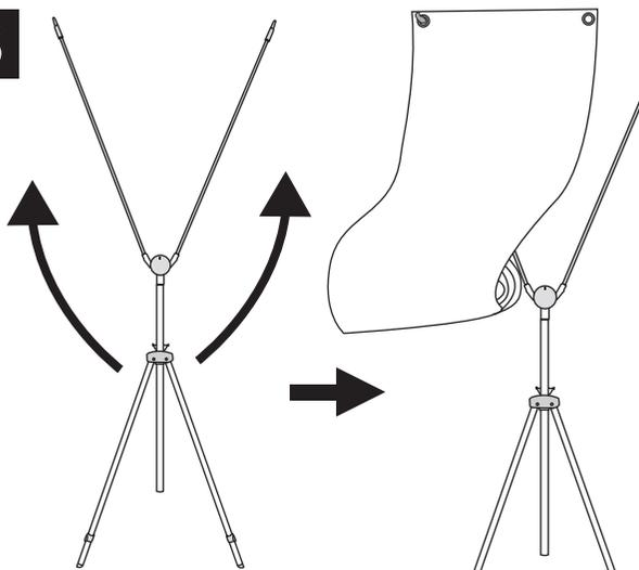
両サイドのバーを広げて、図のようにバナースタンドを取付けます。最初に上側 2 つのハトメ穴に引っ掛けてから下側を引っ掛けます。
