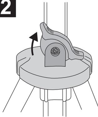
調節後、背面にあるロックバーを図のようにロックします。
