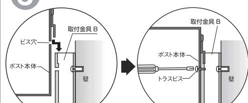
ポスト本体を取付金具 B に引っ掛け、取出口蓋をあけてポストの内側から取付金具 B と本体を付属の M5 トラスビスで 4箇所固定します。
