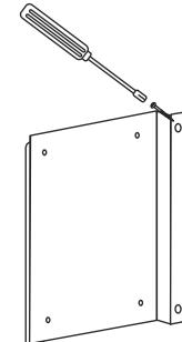
ロウェル取付金具 B を壁面にナベネジでねじ込み固定します。
