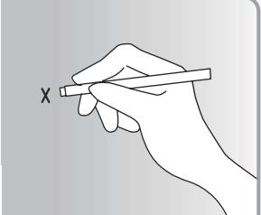
左図のサイズを参考に壁面の取付けたい位置に、ペン等でネジ位置に印をつけます。
