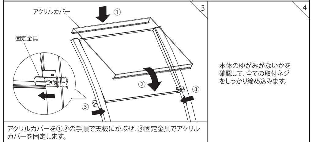
①②の手順で天板にかぶせ、③固定金具でアクリルカバーを固定します。
