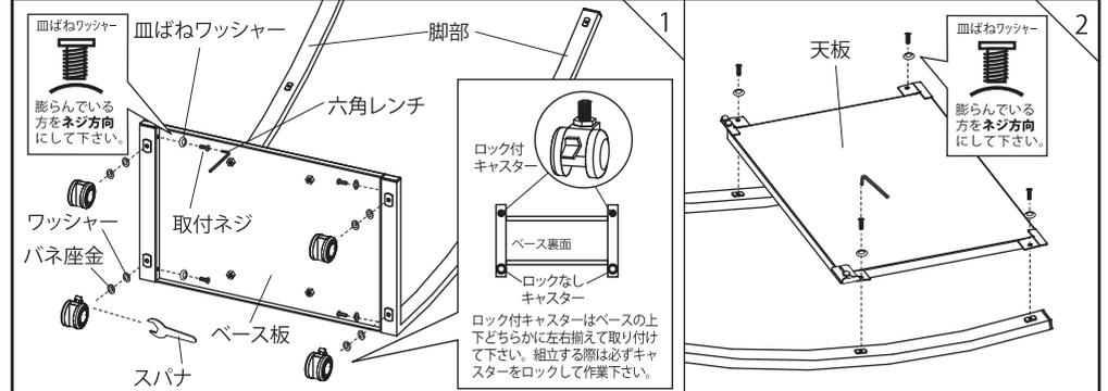
脚部とベースを六角レンチを使って皿ばねワッシャーと取付ネジで固定します。脚部にキャスターをスパナで取り付けます。
