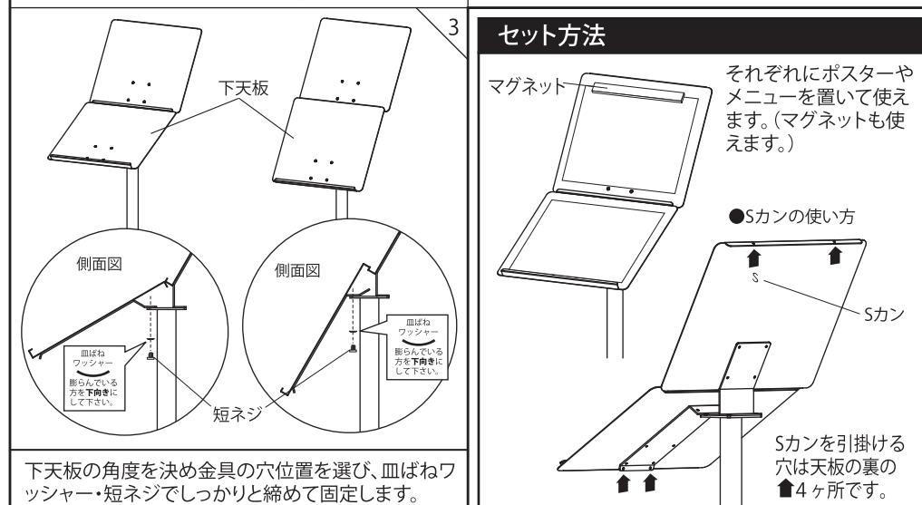
下天板の角度を決め金具の穴位置を選び、皿ばねワッシャー・短ネジでしっかりと締めて固定します。
