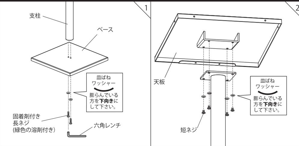
ベースと支柱を血ばねワッシャー・固着剤付き長ネジでしっかりと締めて固定します。(ゆるみ防止のため、支柱とベースの固定に固着剤付きネジを使用していますので、いったんネジを締めるとはずしくなくなります)
