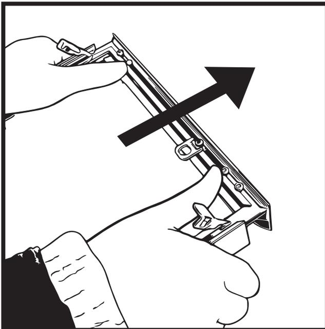
**3** 鉄製ロックレバーを外した辺を、押し上げると1辺が外れるためここからスライドして作品をセットします。
