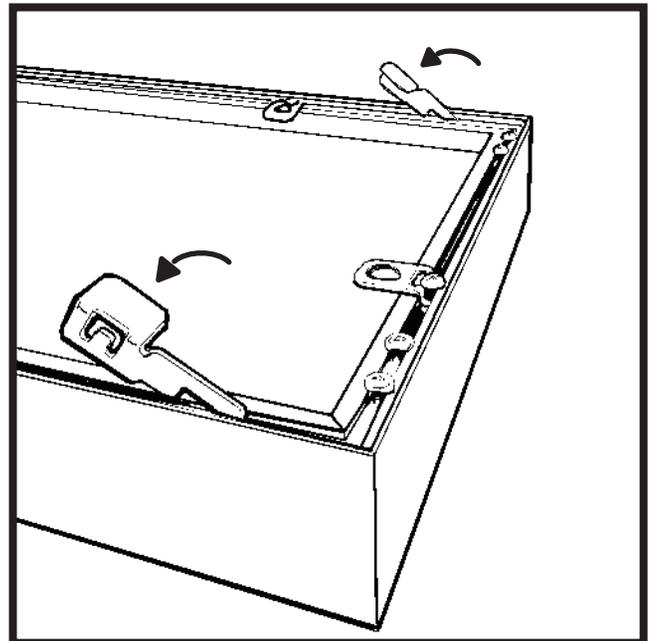
**4** 作品をセット出来たら外した1辺をもう1度差し込み2か所の鉄製ロックレバーを下に下げて完成です。
