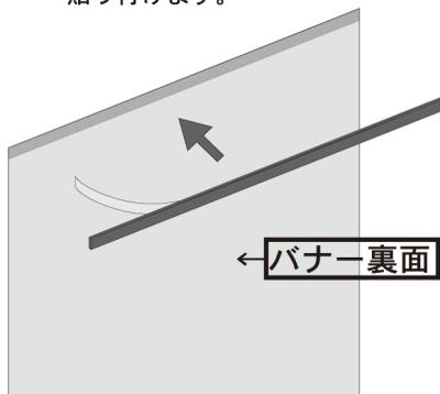
2. アルミバーの溝に合わせて、樹脂バーを貼り付けたバナーをスライドして差し入れます。最後に両サイドにキャップを付けて下さい。
