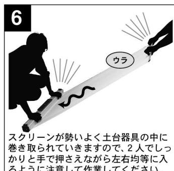
スクリーンが勢いよく土台器具の中に巻き取られていきますので、2人でしっかりと手で押さえながら左右均等に入るように注意して作業してください。
