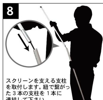
スクリーンを支える支柱を取付します。紐で繋がった3本の支柱を1本に連結して下さい。
