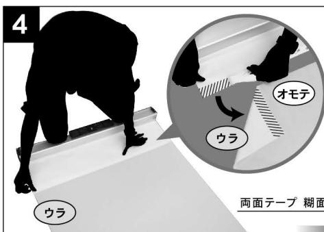
土台器具の両面テープを少しづつ剥がし、スクリーン裏面に両面テープ糊面が付くように貼付けます。
