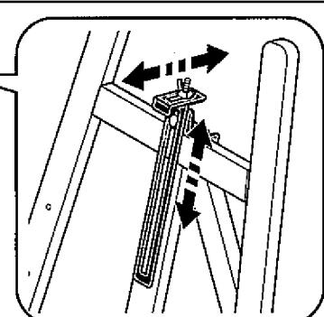
額受けのネジがゆるんでいる場合は一旦ネジを取り外し、付属の接着剠をネジ穴に注入してからネジを入れ直してください。
