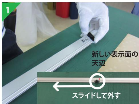
新しい表示面を広げます。上部メディアバーの左右にある黒い樹脂パーツを外し、支柱固定パーツをスライドして外します。
