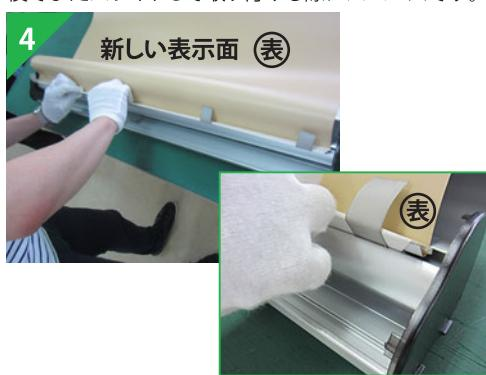
新しい表示面を本体にセットします。表示面の下部についているバナークリップの、リボンが手前に出るように、表示面を畳むようにして本体の溝に奥まで差し込みます。
