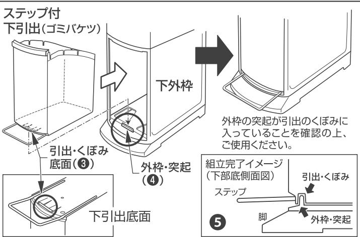
④ステップ付引出を外枠にはめ込む。引出底面の手前にあるくぼみ(3)に外枠の突起(4)が入り込むよう引出を滑らすようにして装着してください。(5)
