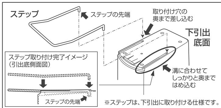
②ステップの先端を下引出(ゴミバケツ)底の取り付け穴に差し込み、溝にしっかりとはまり込むように取り付けます。取り付けが不十分ですと開閉時に引出からステップがはずれる原因となります。
