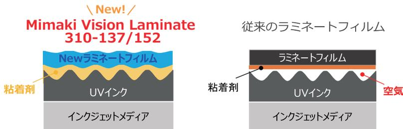
『Mimaki Vision Laminate 310-137/152』は、特別に設計した粘着剤とフィルムを使用しているため UV インクの表面の凹凸に追従しやすく、空気を巻き込みにくい
