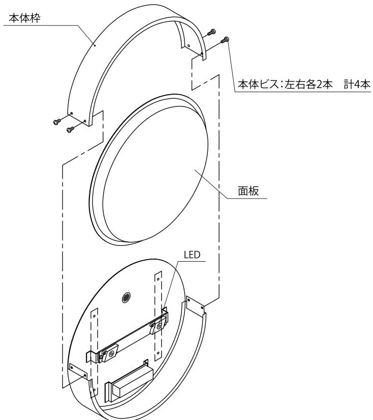
※図例は<壁面440丸 アルミLED>を使用
