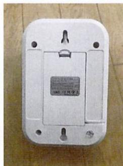
K3 ZERO2（メイン本体）の背面に蓋がありますので、蓋を外して頂き交換して頂きます。
